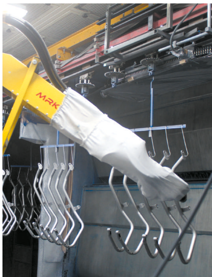
6-9 – Sequenza di un giro a 180° del telaio portapezzi. L'applicazione si effettua con trasportatore in movimento, il girapezzi s'incarica di modificare le velocità relative del gancio per effettuare la sequenza secondo lo schema programmato (a seconda del tipo di pezzi, possono variare i gradi di rotazione). Sequence of a 180° rotation of the piece-holding frame. Application is done with the conveyor in motion; the piece-turning device is responsible for modifying the relative speeds of the hook to perform the sequence according to the programmed scheme (depending on the type of pieces, the positioning degrees may vary).
