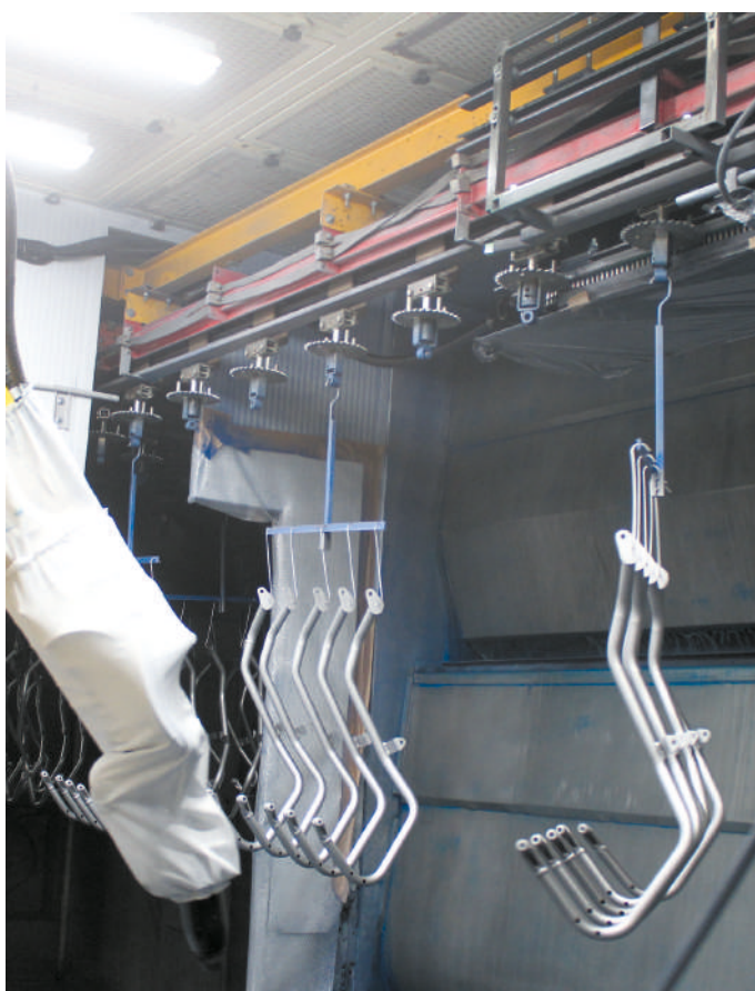
6-9 – Sequenza di un giro a 180° del telaio portapezzi. L'applicazione si effettua con trasportatore in movimento, il girapezzi s'incarica di modificare le velocità relative del gancio per effettuare la sequenza secondo lo schema programmato (a seconda del tipo di pezzi, possono variare i gradi di rotazione). Sequence of a 180° rotation of the piece-holding frame. Application is done with the conveyor in motion; the piece-turning device is responsible for modifying the relative speeds of the hook to perform the sequence according to the programmed scheme (depending on the type of pieces, the positioning degrees may vary).
