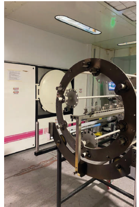
7 - Una delle macchine di metallizzazione PVD sputtering di Kolzer, si noti in primo piano il telaio dove vengono caricati i pezzi da trattare.
