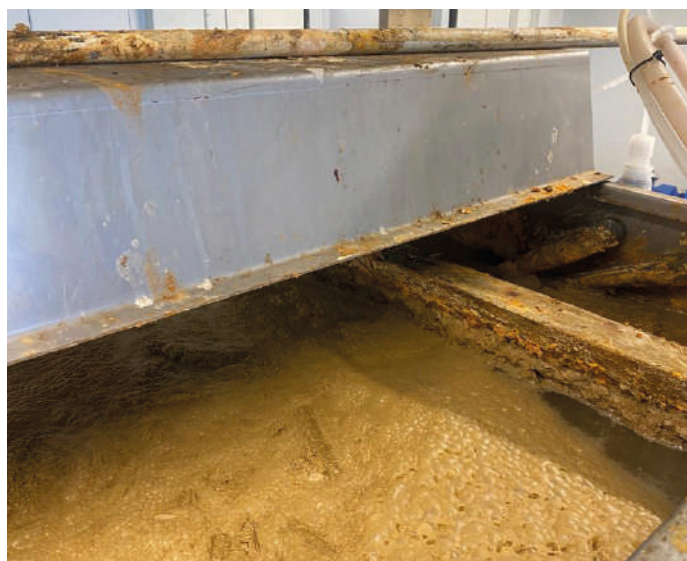
13 – Il prodotto, coagulato in fiocchi, galleggia in superficie. Ciò consente di asportarli tramite una racla.
