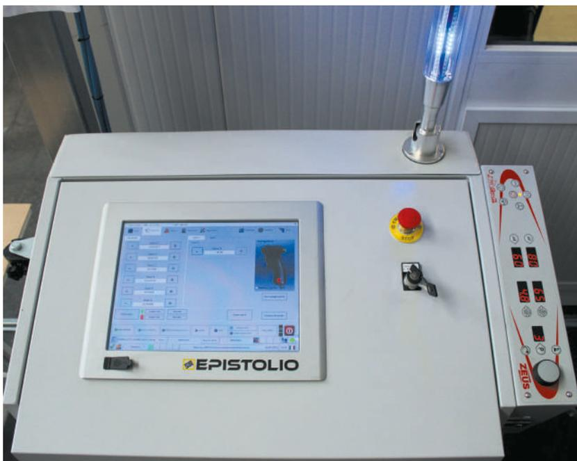
**7 – L'interfaccia di comando di robot e sistema d'applicazione. La programmazione si effettua per autoapprendimento, tuttavia sono sempre possibili modifiche e ottimizzazioni per via digitale.**
