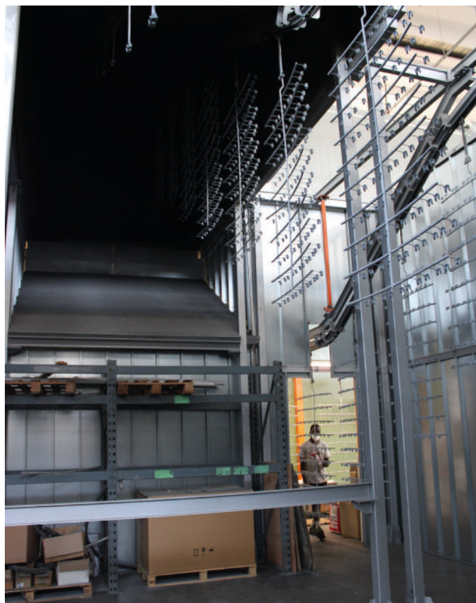
12 - La cabina di verniciatura a polveri di ultima generazione, con cambio colore automatico rapido e due stazioni manuali in ingresso e in uscita
