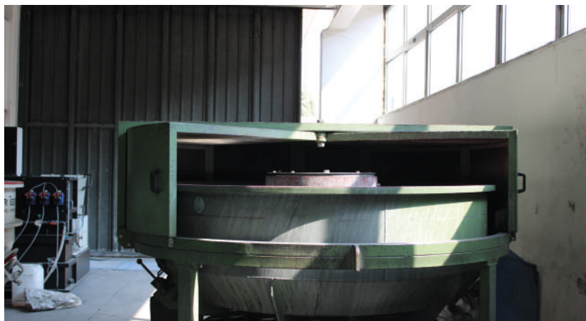
12 - La cabina di verniciatura a polveri di ultima generazione, con cambio colore automatico rapido e due stazioni manuali in ingresso e in uscita
