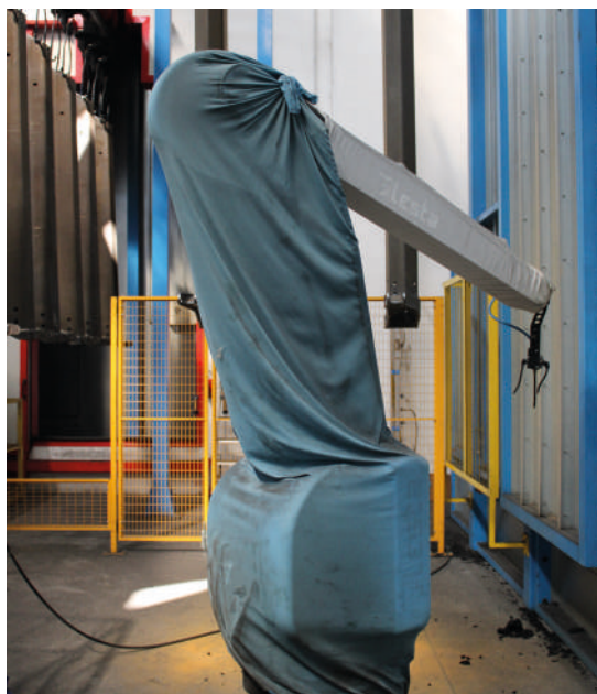
7 - Dettaglio del manipolatore che agevola la fase di carico dei pezzi sul trasportatore
