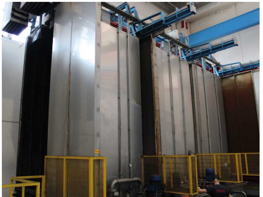
7 - Dettaglio del manipolatore che agevola la fase di carico dei pezzi sul trasportatore
