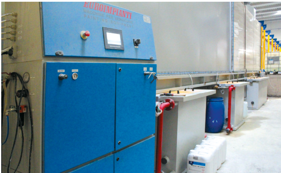
12 e 13 – L'impianto e la macchina di produzione dell'acqua osmotizzata che alimenta la linea di pretrattamento in controcorrente.
