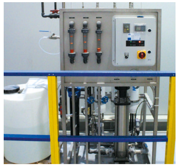
12 e 13 – L'impianto e la macchina di produzione dell'acqua osmotizzata che alimenta la linea di pretrattamento in controcorrente.
