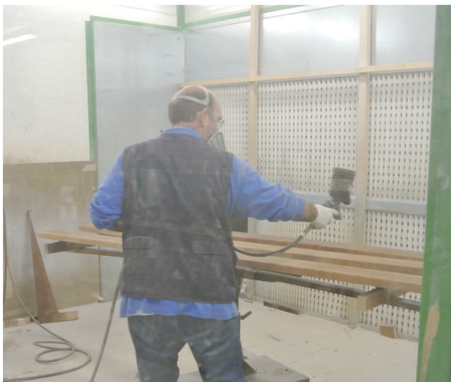
9 – Cabine manuali utilizzate per le finiture particolari, o i ritocchi.
