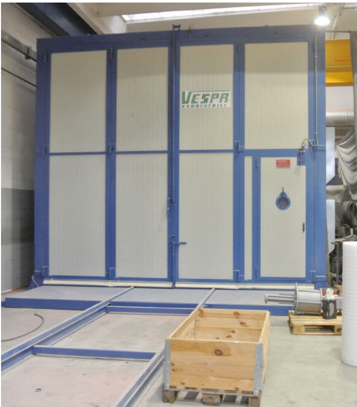
4 - Vista frontale della cabina con portone sezionale con apertura a pacchetto.
