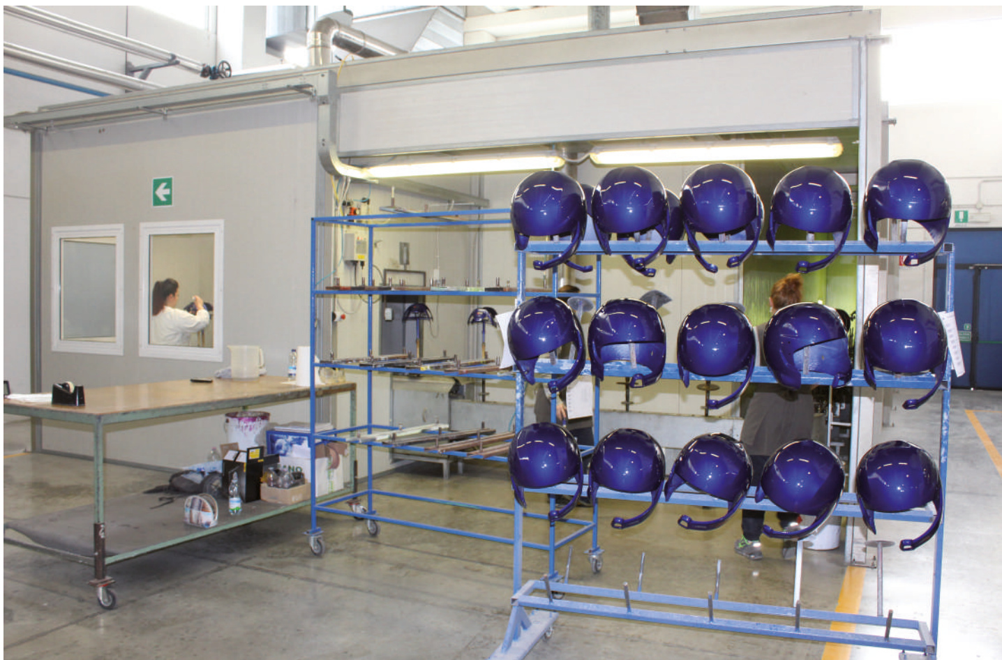
9 – L'impianto per l'applicazione della vernice finale, normalmente trasparente, a polimerizzazione UV, è collocato in area apposita ed è completamente automatizzato.
